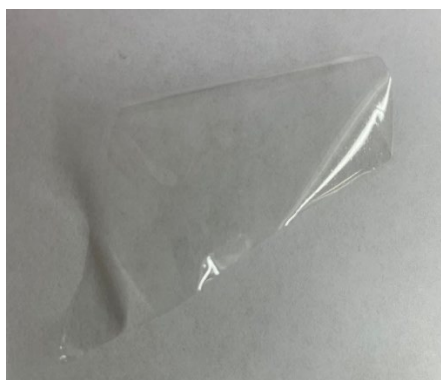
Рисунок 1 – Синтезированный образец нерастворимой в воде хитозановой пленки
