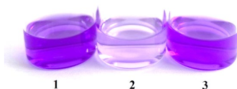
Рисунок 1. Фотография растворов, полученных путем экстракции этиловым спиртом связавшегося с клетками красителя: 1 – контрольный образец, 2 – образец, содержащий цитрат цинка, 3 – образец, содержащий лактат цинка
