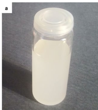
Рис. 1. Фото стабильной дисперсии ППХОЖ в \text{CHCl}_3 (а); гистограмма распределения макромолекулярных ассоциатов в 0.2 мас.% растворе ППХОЖ в \text{CHCl}_3 по данным ДЛС (б)
