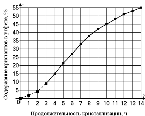
Рис. 2. Кинетика кристаллизации глюкозы с «заводкой» кристаллов в вакуум-аппарате (---) и наращиванием их в кристаллизаторе (—)
