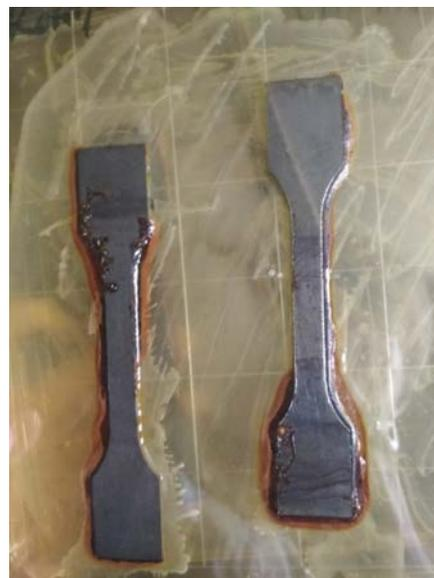
Рисунок 2 – Пластины конструкционной стали СТ-20 в присутствии нитрифицирующих бактерий (через 60 сут. после посева)
