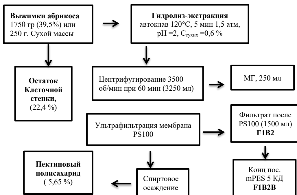
Упрощённая схема выделения ОС из процесса получения пектина
